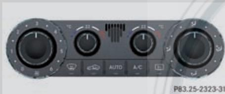
Die Klimatisierungsautomatik 2-ZONEN-THERMATIC ist eine Kombination aus einem automatisch arbeitenden Heizungs- und Belüftungssystem und einer Kühlanlage.
