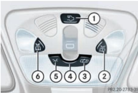
Dachbedieneinheit (CLK Coupé mit Schiebe-Hebe-Dach\*)
